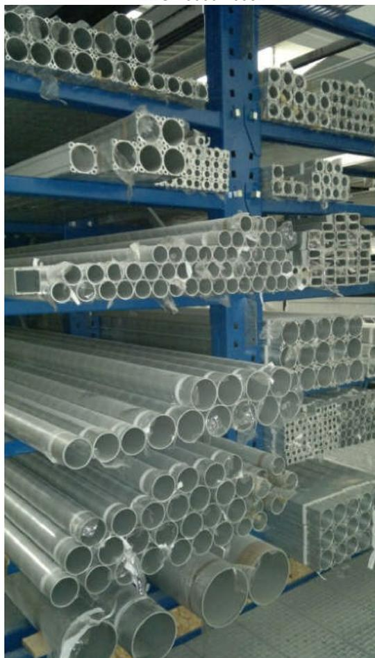
FOTO DI ESEMPIO: PROFILI IN ALLUMINIO ESTRUSO
