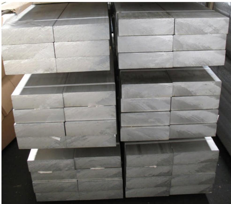
FOTO DI ESEMPIO: PROFILI IN ALLUMINIO ESTRUSO PIATTI DI GRANDI DIMENSIONI
